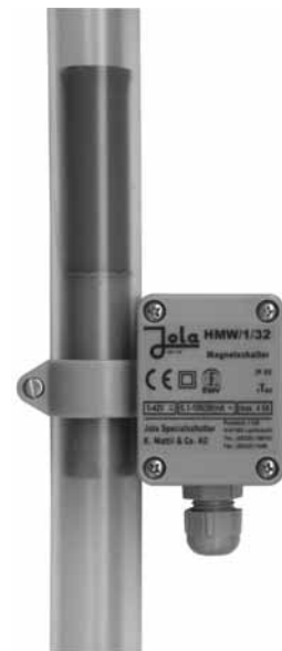
Magneetschakelaar HMW/1/32 bevestigd aan transparante PVC-buis en door PP-vlotter in werking gezet.
