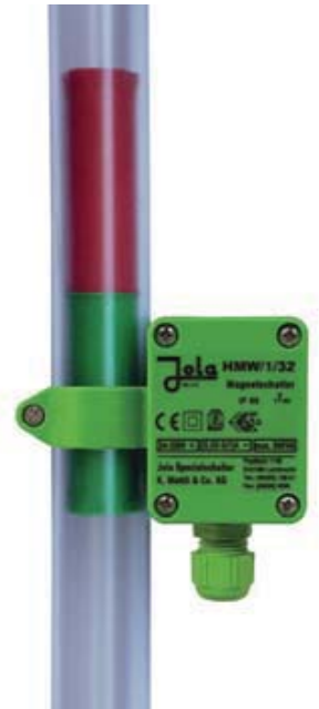
Magnetschalter HMW/1/32 an transparentem PVC-Rohr befestigt und durch PP-Schwimmer beaufschlagt
