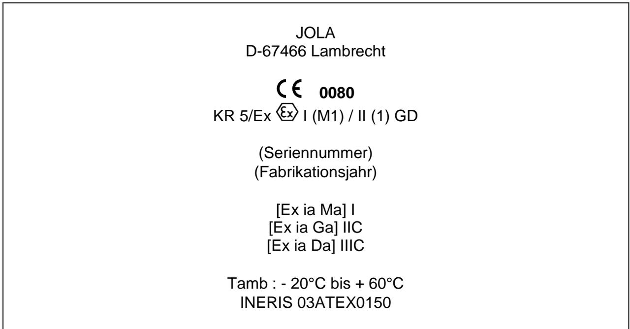
ist dazu bestimmt, elektrische Signale, welche **von einem oder mehreren im explosionsgefährdeten Bereich befindlichen Sensor(en)** kommen, in nicht explosionsgefährdete Bereiche zu übertragen.
