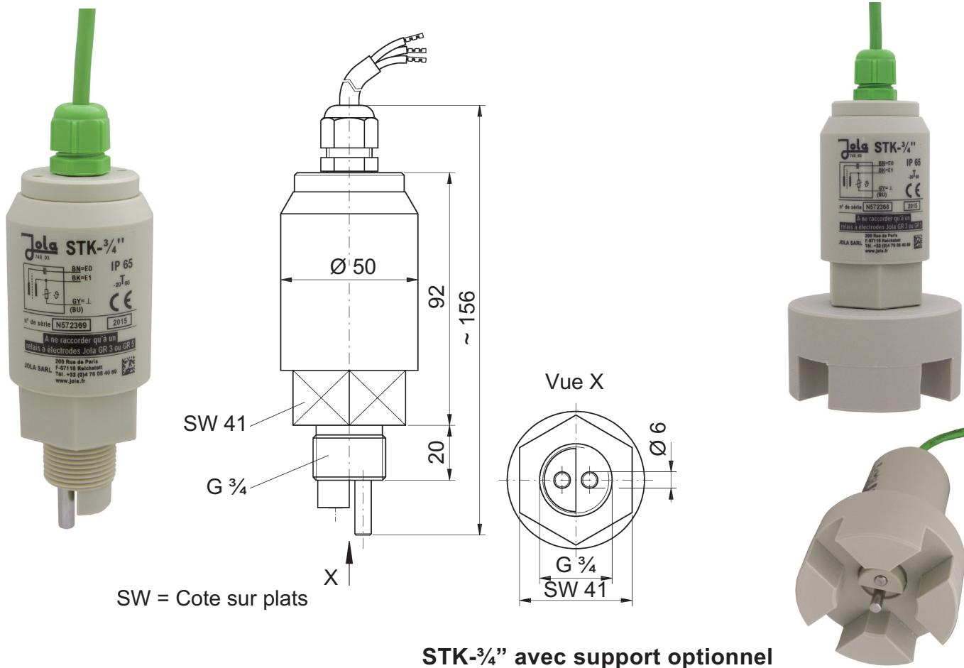
L'électrode-tiges STK- $\frac{3}{4}$ " est une électrode conductive composée de 2 éléments de détection sous forme d'une tige d'électrode en matériau plein (pour mesurer la conductivité) et d'une tige d'électrode sous forme d'un tube fermé avec sonde de température intégrée (pour mesurer la conductivité et pour compenser la température). Elle permet de déclencher un signal d'alarme en présence d'un liquide hautement conducteur (le plus souvent susceptible de polluer l'eau).
