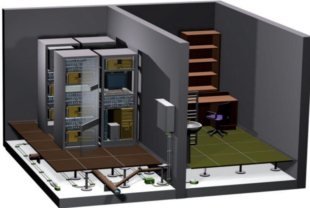
Utilisation d'une électrode à câbles pour la détection d'une fuite de liquide conducteur sous le faux-plancher d'une salle de serveurs et d'une électrode à plaques sous le faux-plancher de la pièce adjacente
