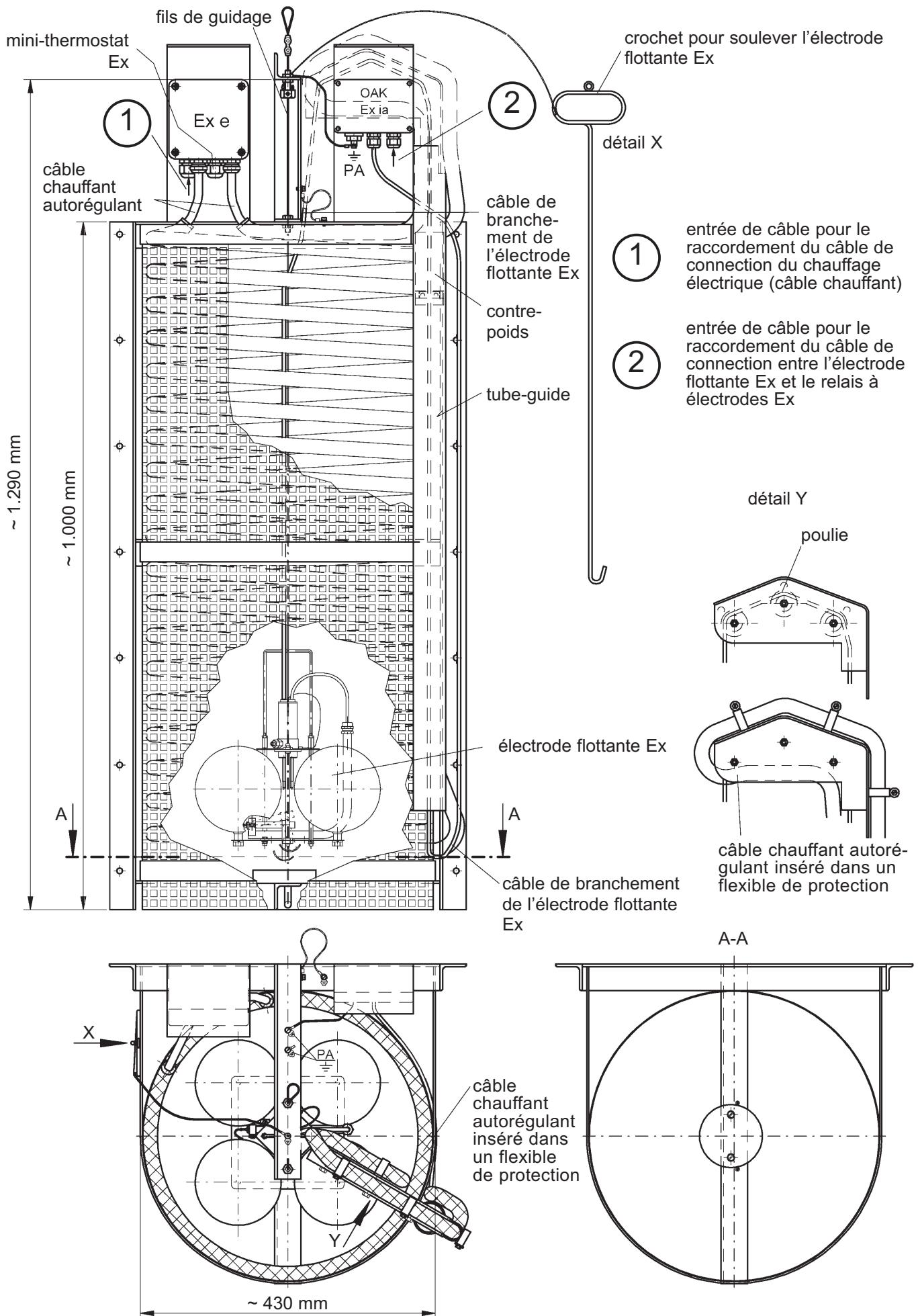
**Des interrupteurs immersés Ex à commande magnétique peuvent être utilisés en option pour réguler des niveaux ou déclencher une alarme (voir dessin ci-contre)**
