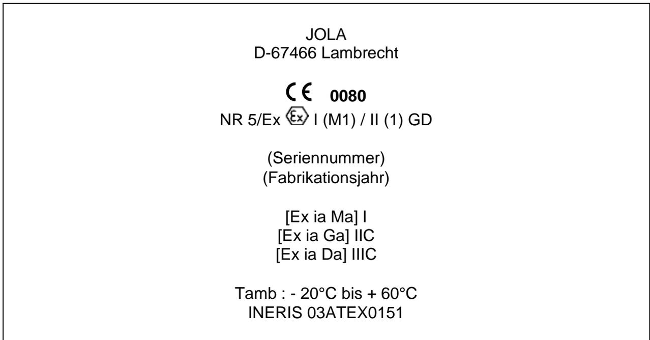
ist dazu bestimmt, elektrische Signale, welche **von einer oder mehreren im explosionsgefährdeten Bereich befindlichen leitenden Elektrode(n)** kommen, in nicht explosionsgefährdete Bereiche zu übertragen.
