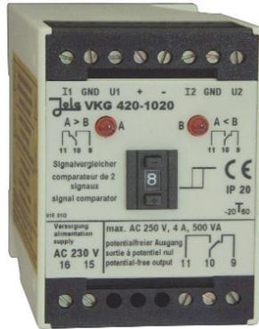
Grenzwertschalter für Signal-Vergleich, für U-Schienen-Montage oder Aufbaumontage, mit obenliegenden Anschlussklemmen, mit Tastkodierschalter zur Einstellung der Hysterese und mit integrierter Speisung von 2 Sensoren.
