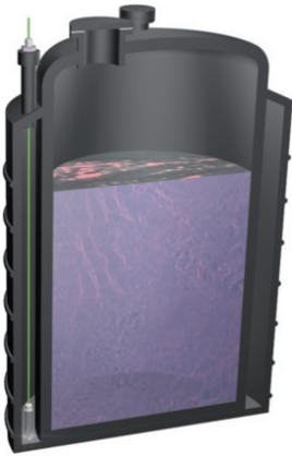
Zur Alarmierung von Präsenz einer **elektrisch nicht leitfähigen oder elektrisch leitfähigen Flüssigkeit**, verursacht z. B. durch Rohrleitungsbruch.
