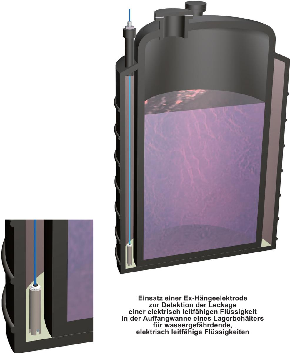
**Einsatz einer Ex-Hängeelektrode zur Detektion der Leckage einer elektrisch leitfähigen Flüssigkeit in der Auffangwanne eines Lagerbehälters für wassergefährdende, elektrisch leitfähige Flüssigkeiten**
