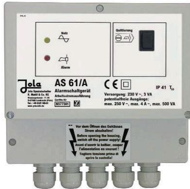
Das **Alarmschaltgerät AS 61/A** dient in Verbindung mit einem Kontaktgeber (z. B. Jola - Schwimmschalter als Schließer an den Klemmen 13 und 14) zur Signalisierung eines Grenzstandes. Die Meldung erfolgt über optisches und akustisches Signal. Für die optische Signalgabe ist eine rote LED im Gehäuse des AS 61/A eingebaut. Für die akustische Signalgabe muss eine externe Hupe an die Klemmen 9 und 10 angeschlossen werden.
