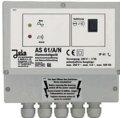
Das **Alarmschaltgerät AS 61/A/N** dient in Verbindung mit einem Kontaktgeber (z. B. Jola - Schwimmschalter als Schließer an den Klemmen 13 und 14) zur Signalisierung eines Grenzstandes. Die Meldung erfolgt über optisches und akustisches Signal. Für die optische Signalgabe ist eine rote LED im Gehäuse des AS 61/A/N eingebaut. Für die akustische Signalgabe muss eine externe Hupe an die Klemmen 9 und 10 angeschlossen werden.
