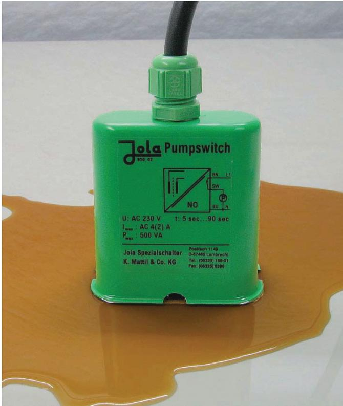
**Der Jola Pumpswitch ist eine konduktive Bodenelektrode mit integrierter Auswerteelektronik und mit ausschaltverzögertem Leistungsrelais zum direkten Schalten einer Flachsauger-Pumpe.**
