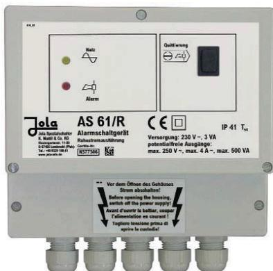
Das **Alarmschaltgerät AS 61/R** dient in Verbindung mit einem Kontaktgeber (z. B. Jola - Schwimmschalter als Öffner an den Klemmen 13 und 14) zur Signalisierung eines Grenzstandes. Die Meldung erfolgt über optisches und akustisches Signal. Für die optische Signalgabe ist eine rote LED im Gehäuse des AS 61/R eingebaut. Für die akustische Signalgabe muss eine externe Hupe an die Klemmen 9 und 10 angeschlossen werden.
